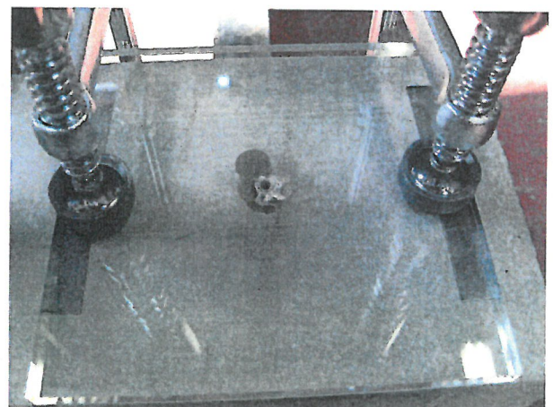
写真-19 試験後の試験体状況 [比較品アンカー，測定箇所3]
