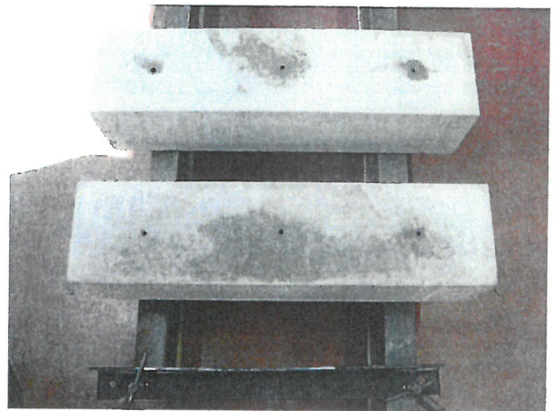
写真-4 母材の作製状況 [湿式二軸低騒音ドリルによる孔あけ状況]
