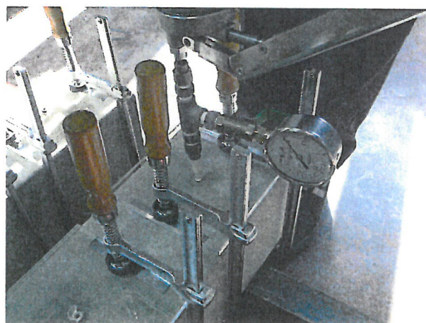
写真-13 試験状況 [接着剤を注入] (比較品アンカー)
