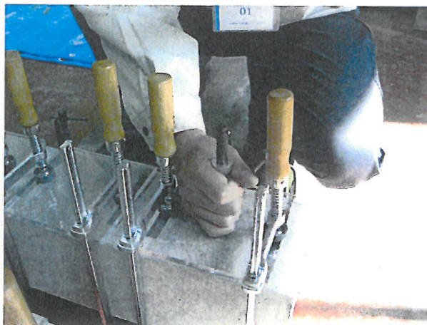
写真-10 試験状況 [試験体の打ち込み] (NBアンカー)
