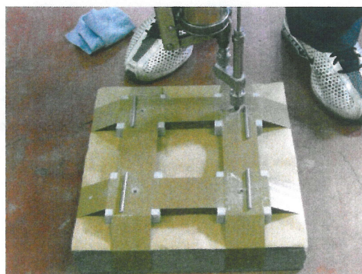
写真-4 接 着 剤 注 入
