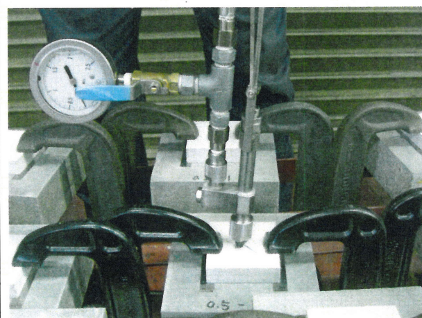
写真-6 接 着 剤 注 入
